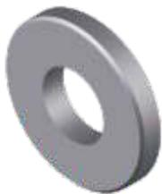
Les rondelles d'étanchéité sont disponibles par progression 0,5mm, c'est à dire quelles combrent 0,4mm de la valeur nominale vers le diamètre plus petit. Pour un foret Ø 5,7, l'on utilise donc une rondelle avec cote nominale 6mm.
